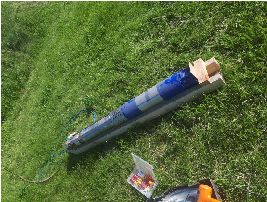
Nowa pompa głębinowa zamontowana w SUW Radomin
